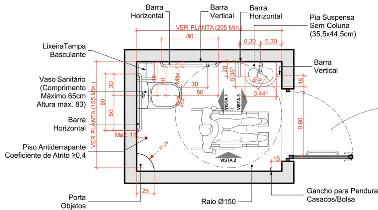
OBSERVAÇÕES: O DIMENSIONAMENTO DO BANHEIRO (MEDIDAS MÍNIMAS) TEM RELAÇÃO COM AS LOUÇAS SANITÁRIAS UTILIZADAS, DEVENDO ASSIM SER RESPEITADAS, PODENDO VARIAR APENAS 5 CENTÍMETROS NA LARGURA. A PIA PODE VARIAR EM SUA ALTURA, SENDO A MÁXIMA 16,5 cm.
